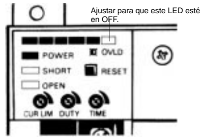
Potenciómetro CUR LIM para limitar corriente.
