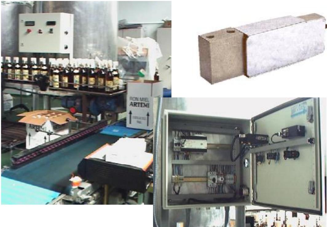
En la cinta de salida de las cajas de licores se ha intercalado una cinta motorizada de pesaje mediante célula de carga, conectada a un visualizador K3NV que envía a un autómata CPM1A de OMRON, en **tiempo real, el valor del peso leído en cada instante.**
