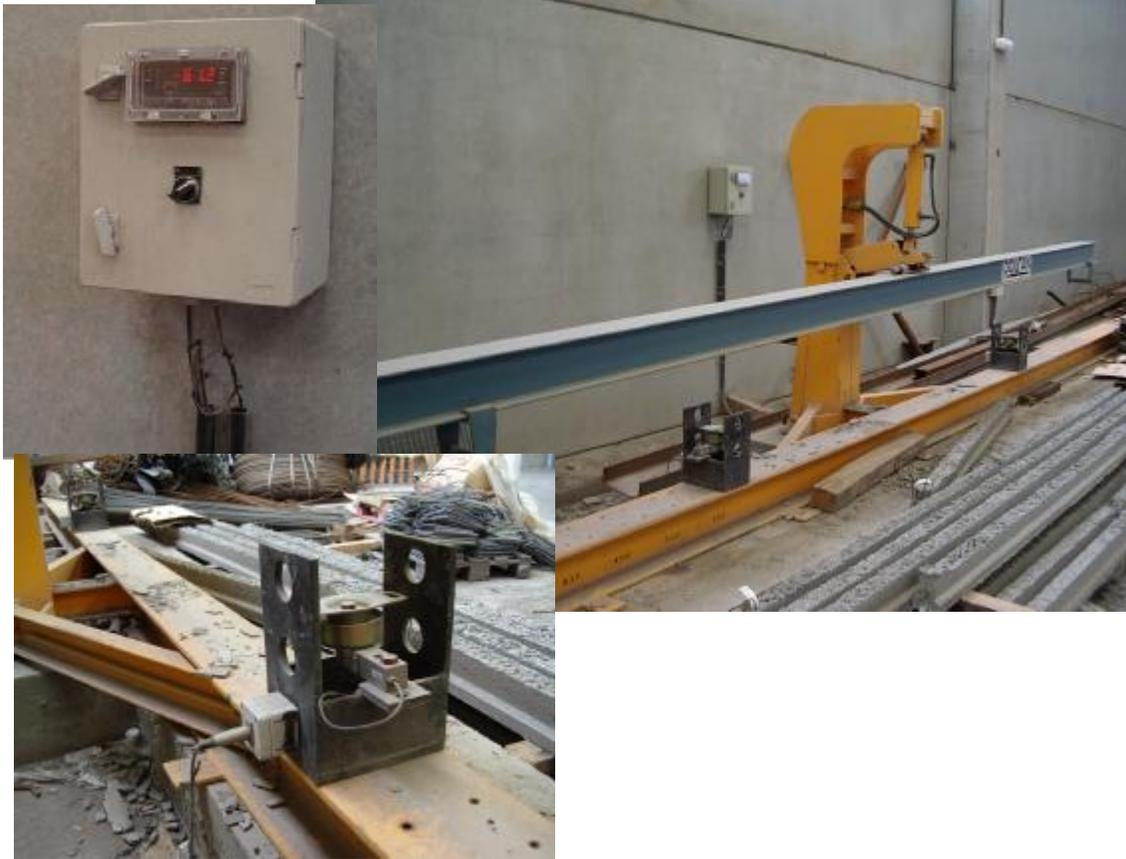
En la fabricación de viguetas es necesario realizar una serie de ensayos sobre el producto terminado para verificar su punto de rotura.
