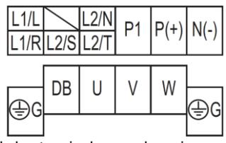
La disposición de los terminales puede variar según la potencia del variador.
